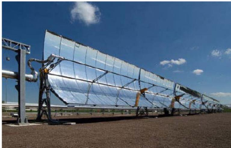
Figura 16 – Tecnologia ENEA in prova presso il centro della Casaccia
