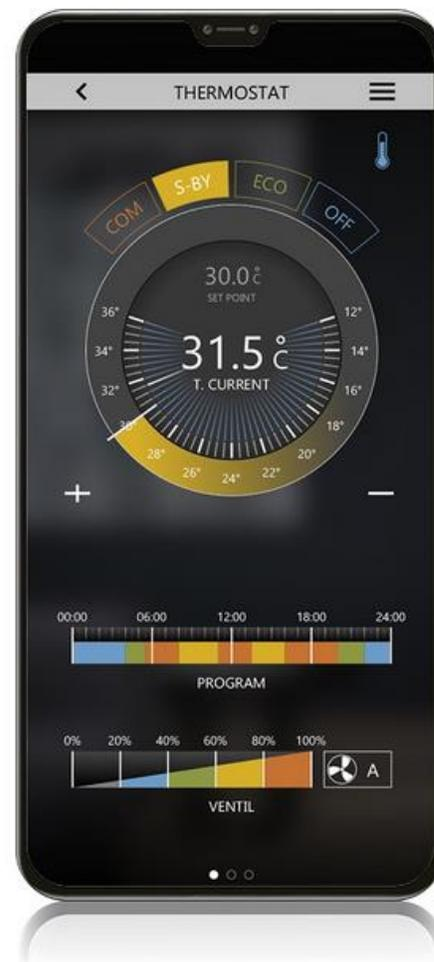
Widget controllo temperatura ambiente: attiva il funzionamento automatico/manuale di un terminale fan-coil. Richiama uno scenario per spegnere completamente l'impianto a più zone tramite ad orari programmati.
