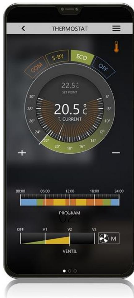
Widget controllo temperatura ambiente: con un tap passi alla modalità risparmio energetico, modifichi la temperatura desiderata manualmente o richiami il funzionamento automatico con un programma orario settimanale.
