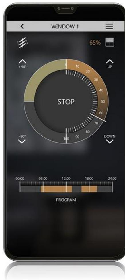
Widget motorizzazioni su/giù percentuale e lamelle su/giù stop: agendo sullo slider sulla corona circolare puoi posizionare in modo preciso le veneziane all'apertura intermedia desiderata; con un tap sulla parte centrale regoli l'inclinazione delle lamelle.
