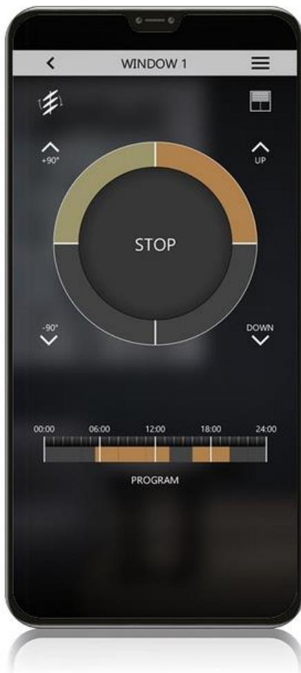
Widget motorizzazioni su/giù lamelle: tramite un tap nella parte centrale del widget controlli l'apertura e la chiusura delle veneziane e attivi l'inclinazione delle lamelle.
