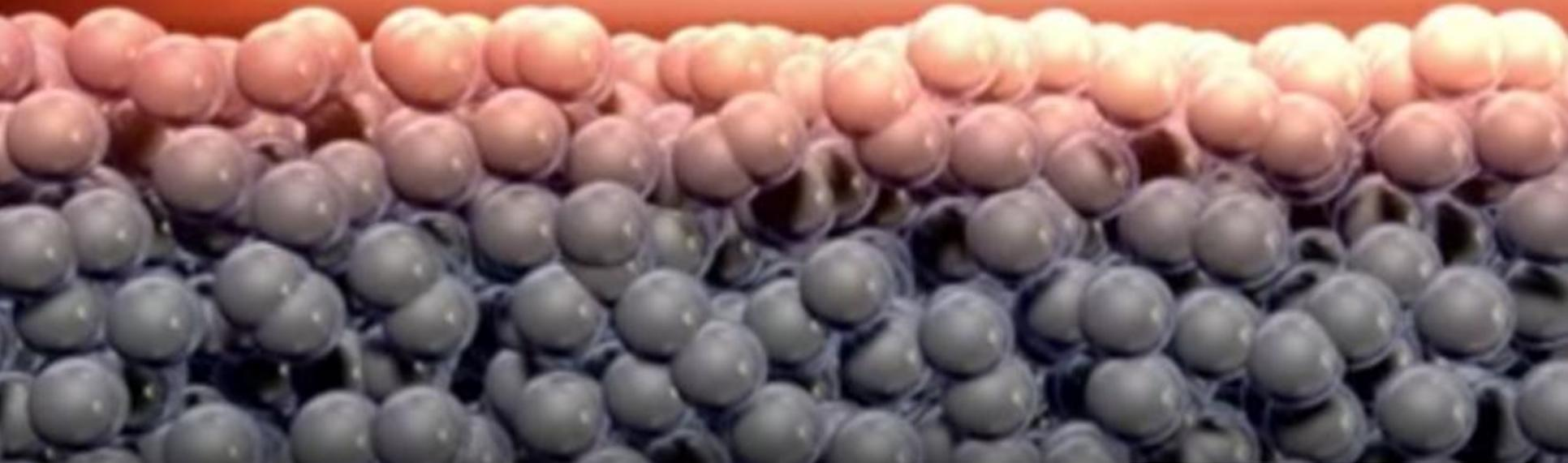
Il cuore della tecnologia sono le microsfere di ceramica vacuizzate e il mix design che rende la MEA unica
