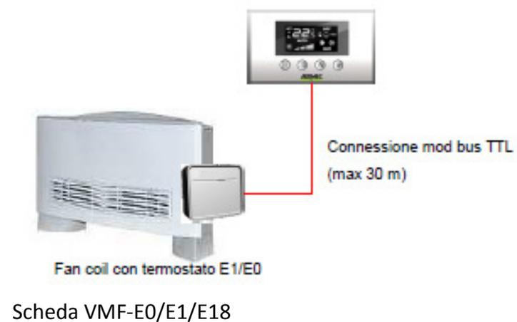
*Impianto con “controllore di zona” con collegamento BUS.*
