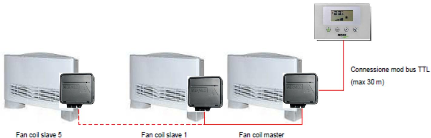
Scheda a bordo di ciascun terminale (dotato anche di sonda aria e acqua)
