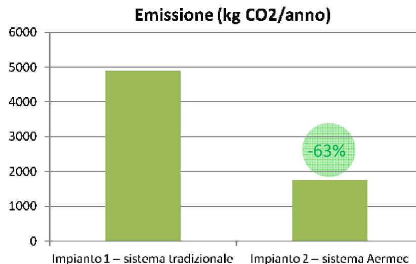
Dai risultati ottenuti emerge che installando una pompa di calore ANLI021H (dotata di tecnologia ad Inverter) con i ventilconvettori, otteniamo un risparmio in termini economici pari ad un **26%** rispetto alla soluzione con caldaia a condensazione.
