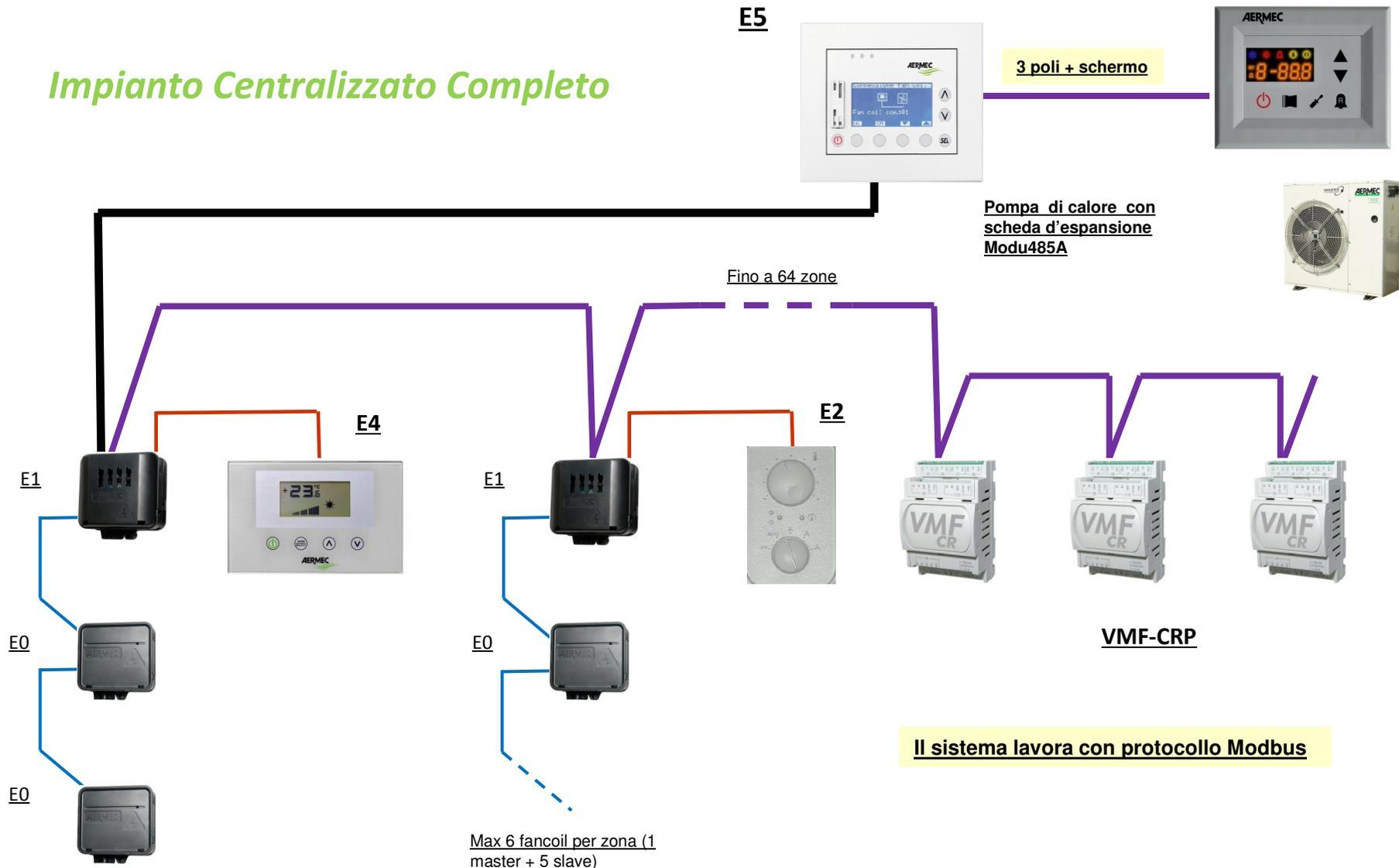
**Il sistema VMF presenta un' innovativa piattaforma di controllo per la gestione integrata dei sistemi di tipo IDRONICO.**
