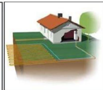
Figura 37 Sonde geotermiche: configurazione verticale e configurazione orizzontale.
