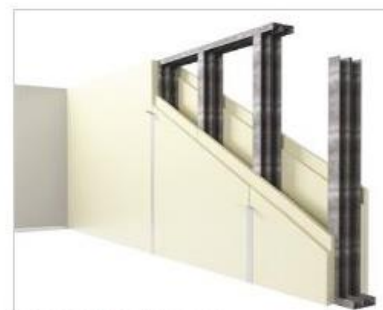
W115 GKF EI120 Rw62 W115 – Ignilastra GKF – Rw 62 dB – EI 120
