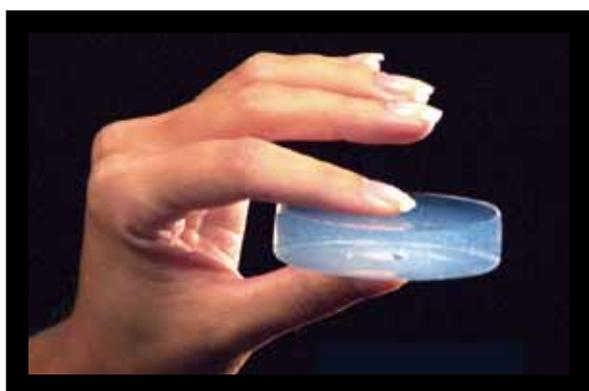
Isolare con un materiale leggero come l'aria, ma due volte più impermeabile al calore: è quanto promettono i nuovi pannelli Aeropan, pensati per migliorare le prestazioni di case esistenti senza interventi troppo invasivi
