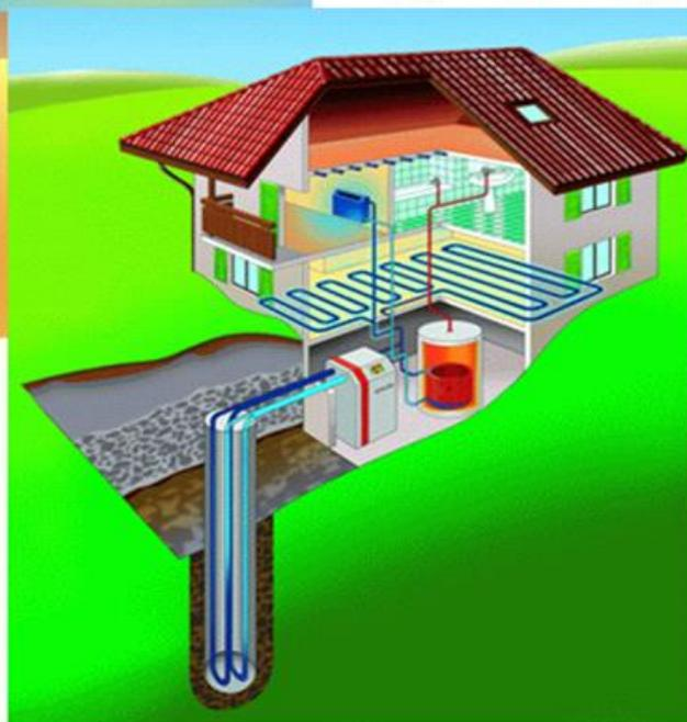
**In estate** il calore in eccesso presente nella casa viene eliminato trasportandolo nel sottosuolo attraverso lo scambiatore di calore.
