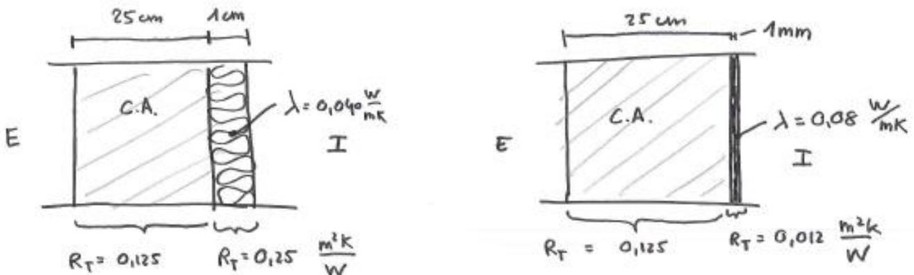
*Caso 1: un materiale isolante da 1 cm con conduttività termica  $0,04 \text{ W/mK}$  ha una resistenza termica pari a  $R_t = 0,25 \text{ m}^2\text{K/W}$*
