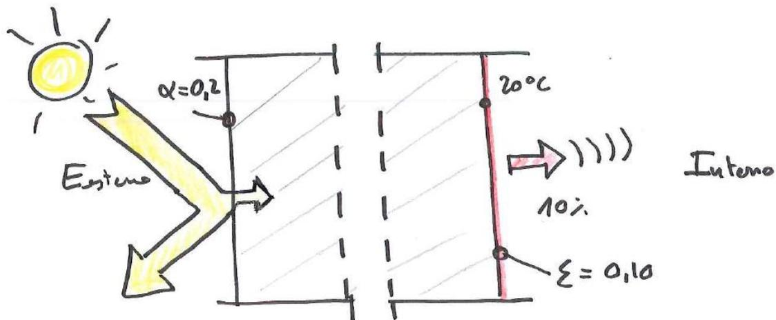
*Caso 3. rivestimento esterno basso assorbente rispetto al campo della radiazione solare ( $\alpha = 0.2$ ) e rivestimento interno basso emissivo rispetto al campo della radiazione termica: all'esterno la parete si scalda poco poiché riflette gran parte dell'energia solare incidente e all'interno la parete a 20°C scambia poca energia sotto forma di radiazione termica (solo il 10%) con l'ambiente interno (questa riduzione di scambio è una forma di isolamento termico).*
