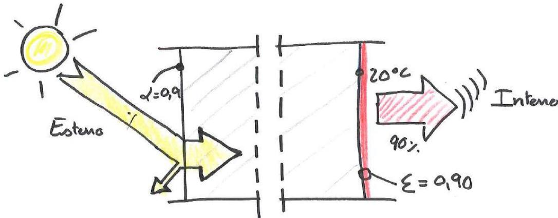
*Caso 4. Rivestimento esterno alto assorbente rispetto al campo della radiazione solare ( $\alpha = 0.9$ ) e rivestimento interno alto emissivo rispetto al campo della radiazione termica: all'esterno la parete si scalda molto e all'interno la parete a 20°C scambia molta energia sotto forma di radiazione termica (il 90%) con l'ambiente interno (questa forma di scambio non è una forma di isolamento termico).*
