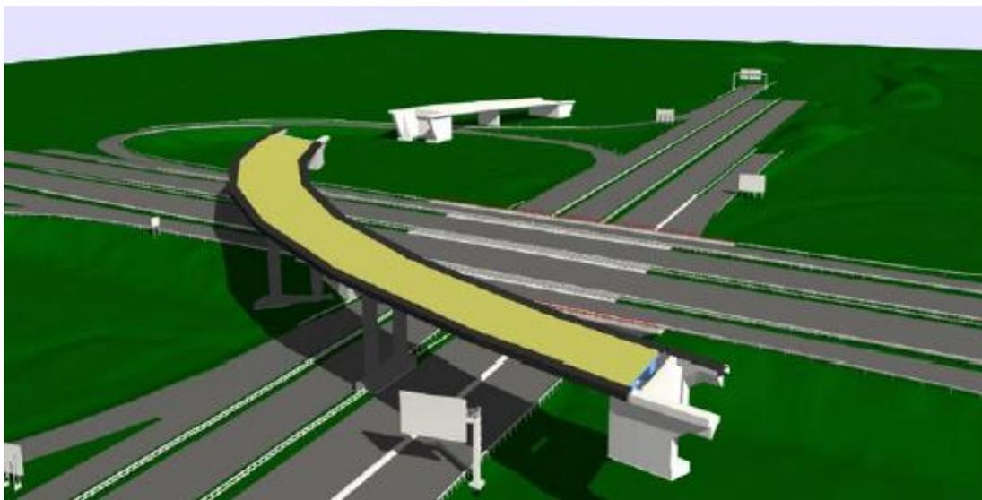
Abbildung 74: 3D-Entwurfsplanung des Überfliegers basierend auf dem 3D-Geländemodell (Quelle: SSF Ingenieure AG)
