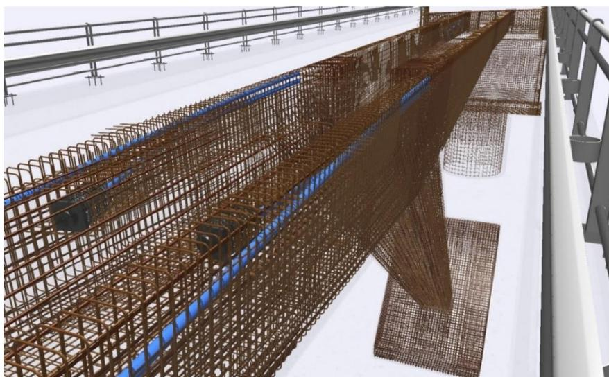
Abbildung 13: BIM Modell der Versamertobelbrücke (Quelle: Nemetschek 2015)
