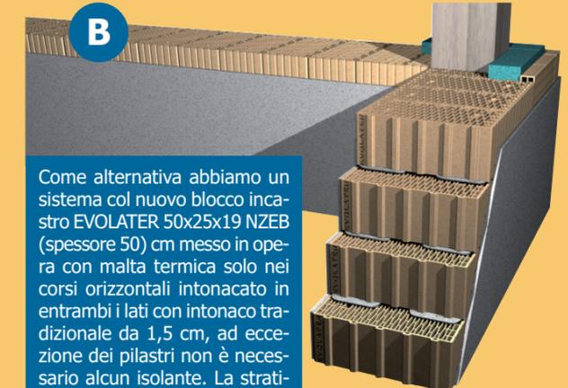
Come alternativa abbiamo un sistema col nuovo blocco incastro EVOLATER 50x25x19 NZEB (spessore 50) cm messo in opera con malta termica solo nei corsi orizzontali intonacato in entrambi i lati con intonaco tradizionale da 1,5 cm, ad eccezione dei pilastri non è necessario alcun isolante. La stratigrafia della parete è la seguente:
