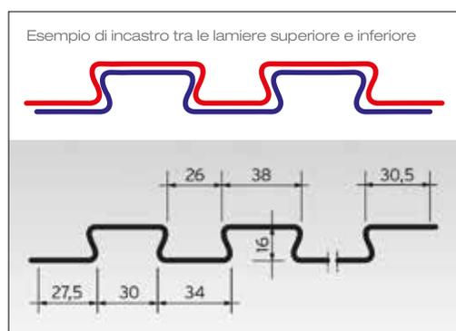
**Specifiche delle lastre a coda di rondine Solaio Facile**
