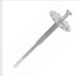
Tassello universale a percussione con chiodo in acciaio e perno di montaggio in materiale sintetico, da 95 a 255 mm
