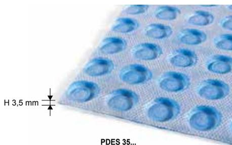
**PRODES** è una membrana impermeabilizzante e desolidarizzante in polietilene a bassa densità provvista di cavità circolari e rivestita su ambo i lati di un tessuto non tessuto in polipropilene termosaldato che garantisce l'adesione al supporto e l'ancoraggio alla pavimentazione
