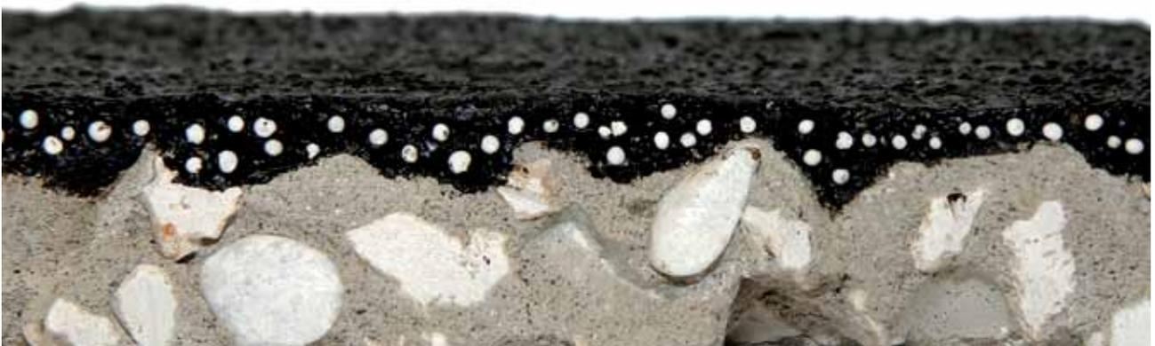
*Ingrandimento della sezione di un supporto irregolare impermeabilizzato con Aquabit.*
