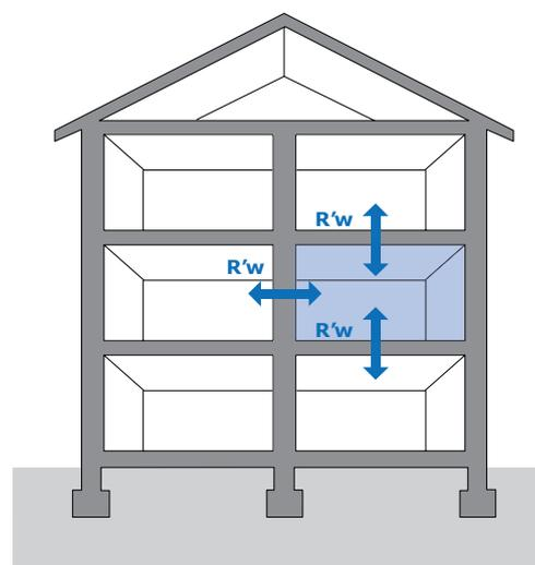
La classificazione acustica delle unità immobiliari si riferisce a misurazioni in opera delle prestazioni acustiche degli elementi tecnici. In figura si mostra l'esempio delle prestazioni di isolamento ai rumori aerei: il valore di  $R'w$  è calcolato come media energetica dei singoli valori misurati per i divisori interni verticali e orizzontali.
