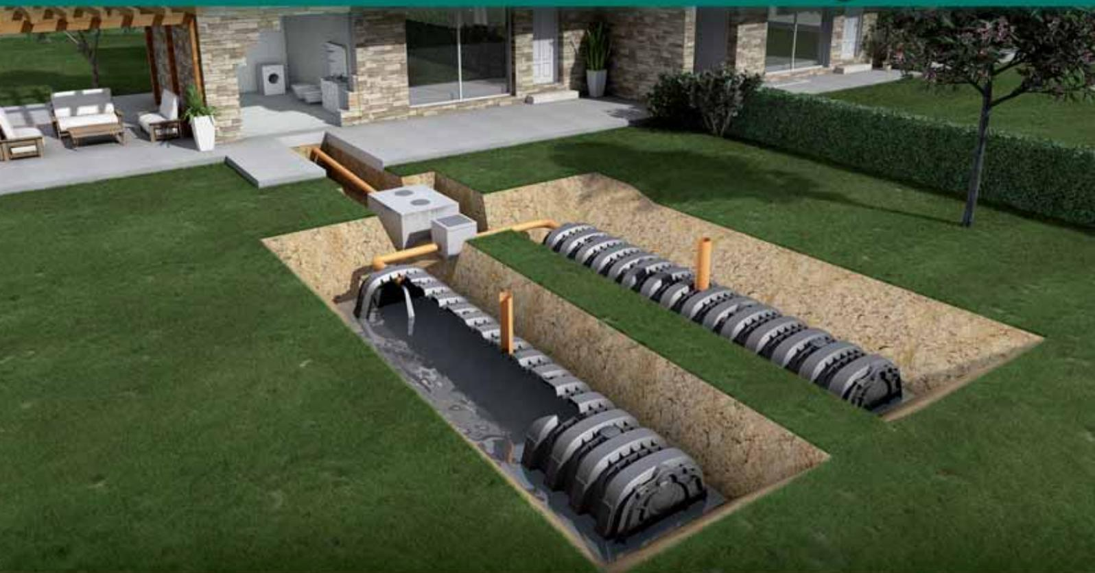
Sistema per il trattamento delle acque reflue
