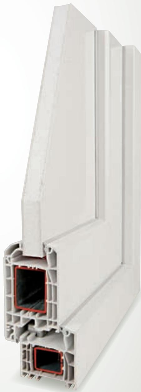
**I**DEAL 5000<sup>®</sup> é un sistema a 5 camere con uno spessore di 70 mm e 3 diverse guarnizioni di tenuta: due guarnizioni sono poste sull'anta e una sul telaio per un eccellente isolamento termico e acustico. L'atmosfera sicura e piacevole assicurata dai profili di questa serie determina la qualità della vita tra le mura domestiche.
