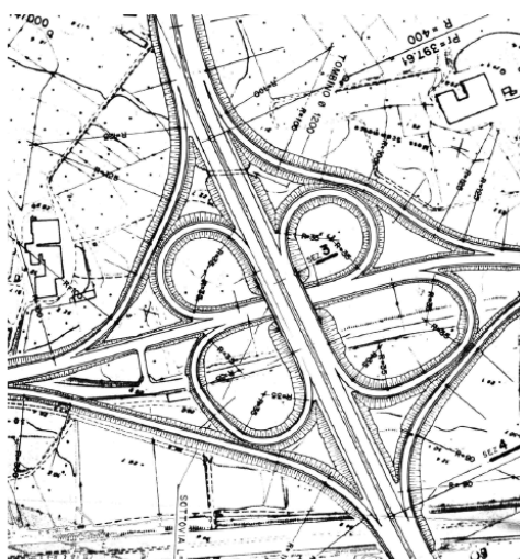
Fig. 7: svincolo a quadrifoglio
